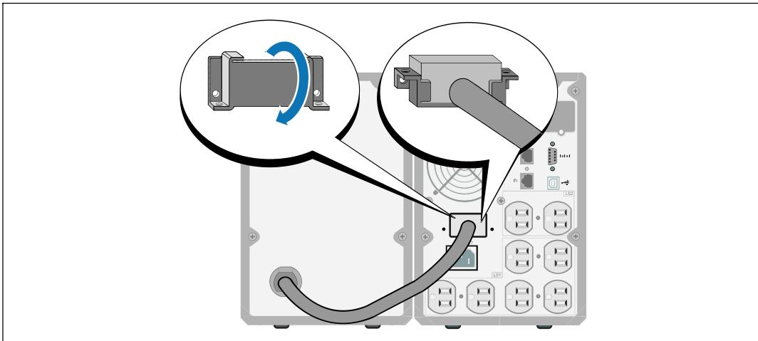
**3** Installez le couvercle du connecteur des batteries sous le câble de l'EBM pour servir de serre-câble.
