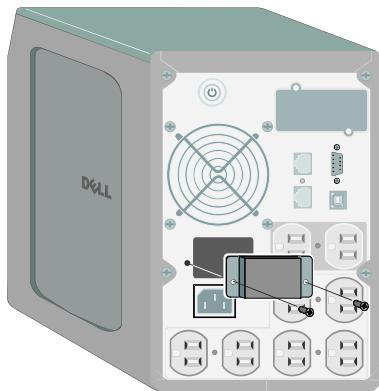
**NOTA:** Puede haber un pequeño arco al momento de conectar un EBM al UPS. Esto es normal y no ocasionará daños personales. Inserte el cable del EBM en el conector de la batería del UPS de forma rápida y firme.
