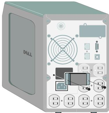
**注記：** 外付けバッテリーモジュールをUPSに接続する際、少量のアーク放電が起こることがあります。これは正常であり、人に損傷を与えることはありません。即座にしっかりと、外付けバッテリーモジュールケーブルをUPSバッテリーコネクタへ挿入します。
